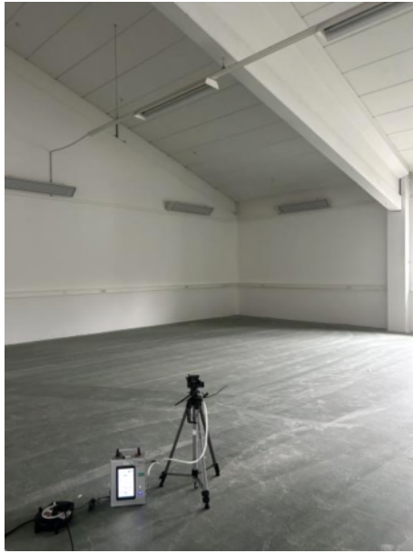
Abbildung 8. Raumluftprobenahme im Raum ME 8 OG.
