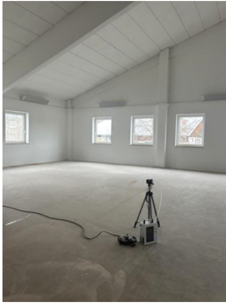
Abbildung 6. Raumluftprobenahme im Raum ME 7 (Nord), OG.
